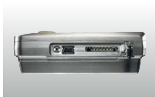
Boční připojení mini-USB kabelu a SD karty
