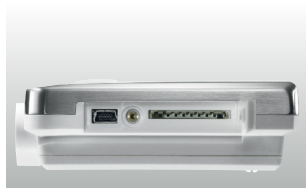
Boční připojení mini-USB kabelu a SD karty
