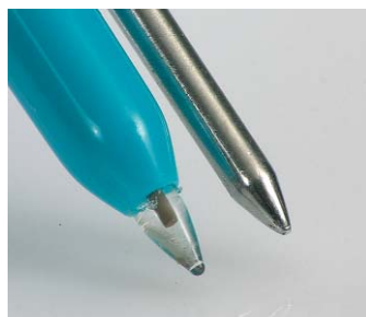
pH2- vpichovací sonda do polotuhých materiálů
