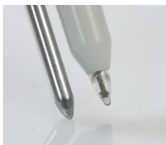
Špička pH elektrody je chráněna plastem, aby se zvýšila její odolnost proti zlomení
