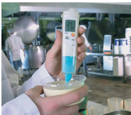
pH metr testo 206-pH2 je ideální pro měření polotuhých médií
