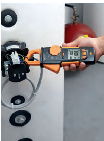
Meranie napätia na tepelnom zásobníku prístrojom testo 770.
